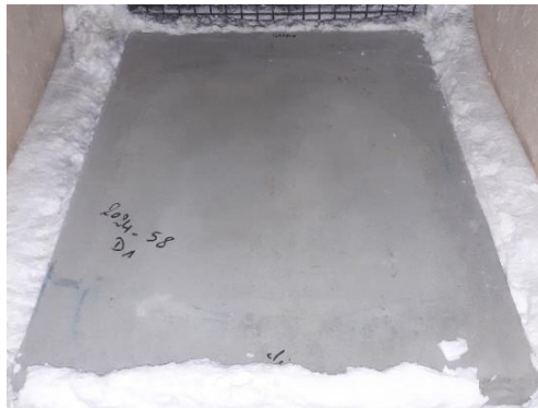
Photo de la face exposée au feu avant et après essai de la dalle 2024-58-D1
